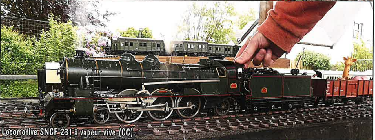
Locomotive à vapeur vive en cours de chauffe comme en témoigne l'extracteur de fumée fixé sur de la cheminée (CC).
