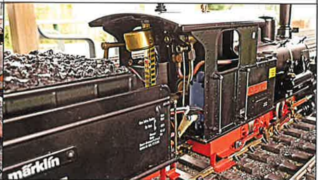
Locomotive à vapeur vive en cours de chauffe comme en témoigne l'extracteur de fumée fixé sur de la cheminée (CC).
